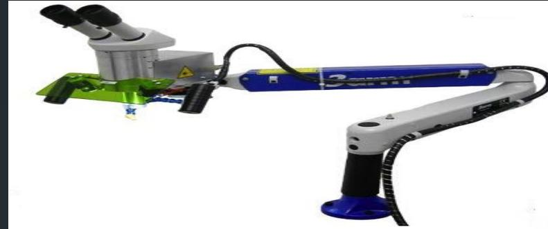
formé de 2 tubes rigides et légers, de 6 articulations, sur lequel peut être connecté une pièce à main, un système à balayage ou un scanner.
