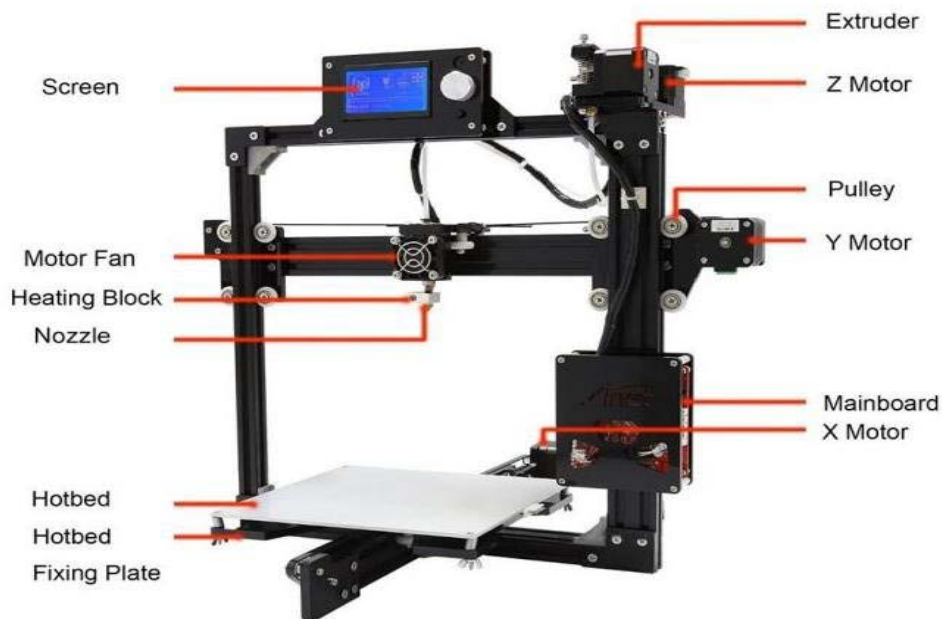
Figure 18 les différents composants d'une imprimante 3D. [45]
